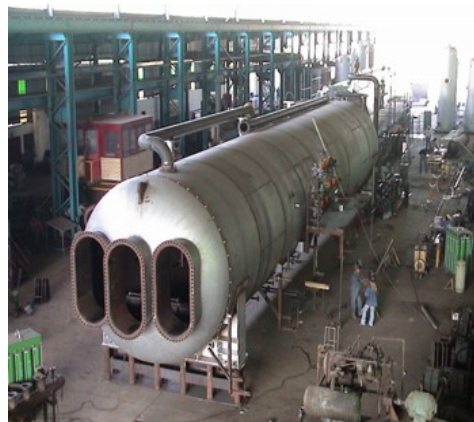
Separador diseñado y fabricado por empresa venezolana
