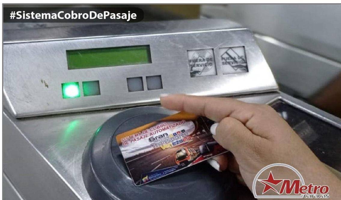
Imagen N° 25. Lectora de tarjetas de proximidad en el Metro de Caracas
